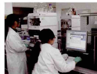
用高压液相色谱仪检测酶降解后的小分子物质
