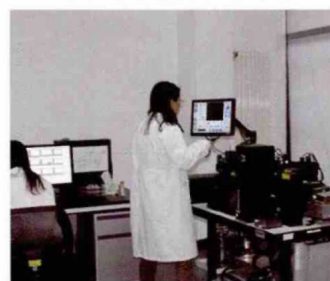
用流式细胞仪对产酶微生物细胞进行高通量筛选
